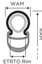
Compatibilité des jantes développée sous Normes ETRTO : vérifier soigneusement la largeur de la jante avant utilisation.
