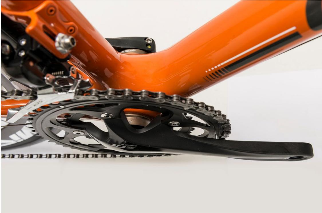
Des renforts en fibres 3K sont ajoutés dans les zones sensibles comme le boîtier de pédalier pour offrir un bon rendement. Très classique, le cadre Axxome offre une rigidité latérale infaillible. Il ne bronche pas. Efficace et fluide, sa géométrie engage l'oscillation aisée de la roue avant. Il se montre vif et agressif dans toutes les conditions et confirme une vocation « compétition ».
