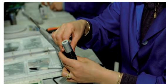
Chez LOOK, les cadres et accessoires en carbone sont fabriqués à la main. Il faut en moyenne une trentaine d'heures pour réaliser un cadre en carbone.
