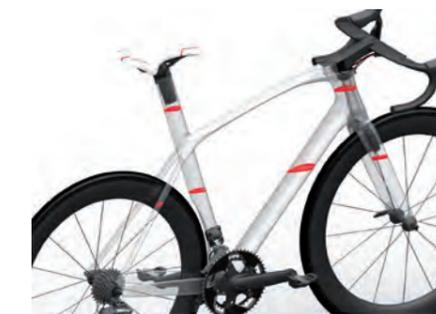
Inspiré de l'aéronautique, les sections de tubes du 795 Aerolight et 795 Light ont un profil NACA\* permettant un écoulement de l'air optimal.
