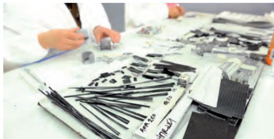
La réalisation d'un cadre en carbone passe par une étape d'assemblage de nombreuses pièces de carbone.
