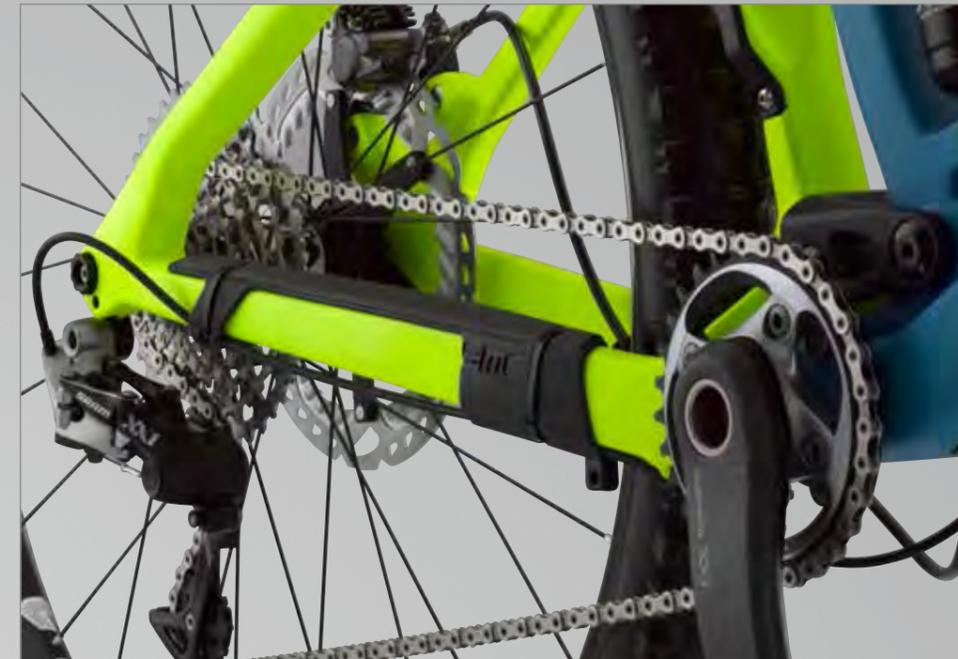
Des détails soignés à tous les étages, avec des protections de cadre injectées pour les bases, un guide chaîne intégré, des plots ISCG05 et un support de dérailleur avant amovible. Le boîtier de pédalier pressfit est muni d'inserts ISCG05.
