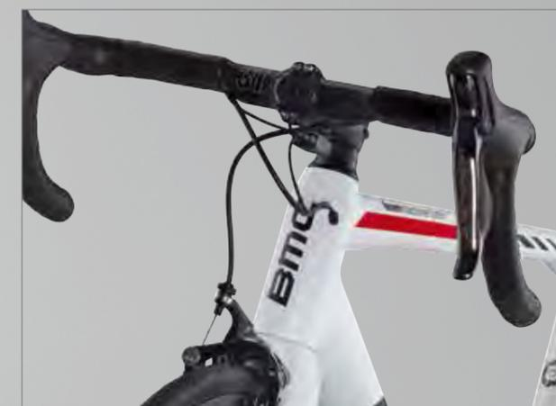
La large connexion du tube supérieur et de la douille de direction est un résultat du calcul ACE technologie. Le câble Di2 court le long de la gaine de frein arrière pour plus de fiabilité.
