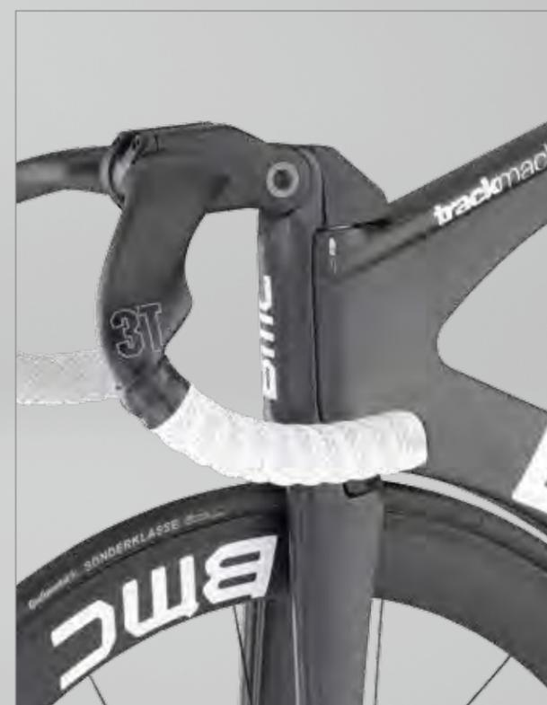
La potence p2p est ajustable en longueur grâce aux entretoises fournies, et en hauteur grâce au point de pivot accouplé à la fourche.
