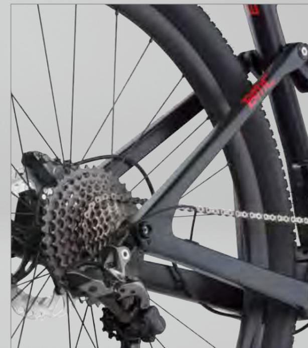
Les pattes du Fourstroke 01 tout carbone sont conçues pour un axe traversant de 12x142mm et son assemblée avec une patte de dérailleur direct mount Shimano ou Sram selon le groupe utilisé.
