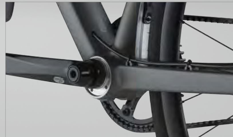
Les modèles AC01 IGH utilisent un boîtier de pédalier excentrique pour garantir une tension optimale de la courroie Gates.
