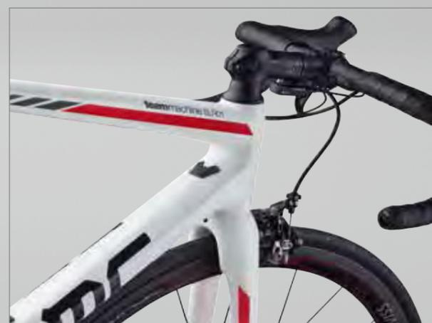
Notre concept DTi (Dual Transmission Intégration) permet un montage propre et sûr de la câblerie, pour tous les types de transmission, dans le tube diagonal et sous le boîtier de pédalier.
