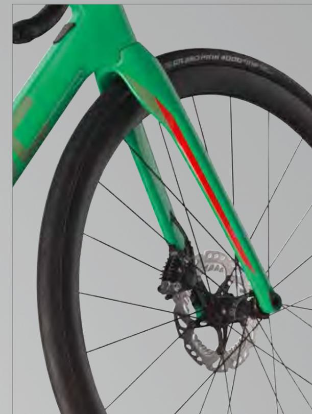
Le frein à disque avant du Roadmachine est équipé d'un flatmount compatible 140/160mm propre à BMC pour une intégration maximale et un design harmonieux.
