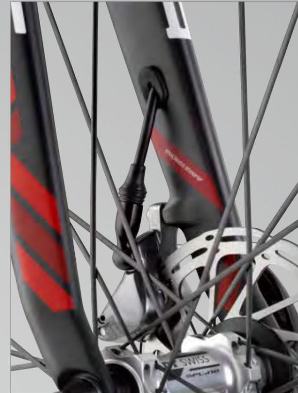
La câblerie est proprement intégrée au cadre et conçue pour les freins à disques hydrauliques.
