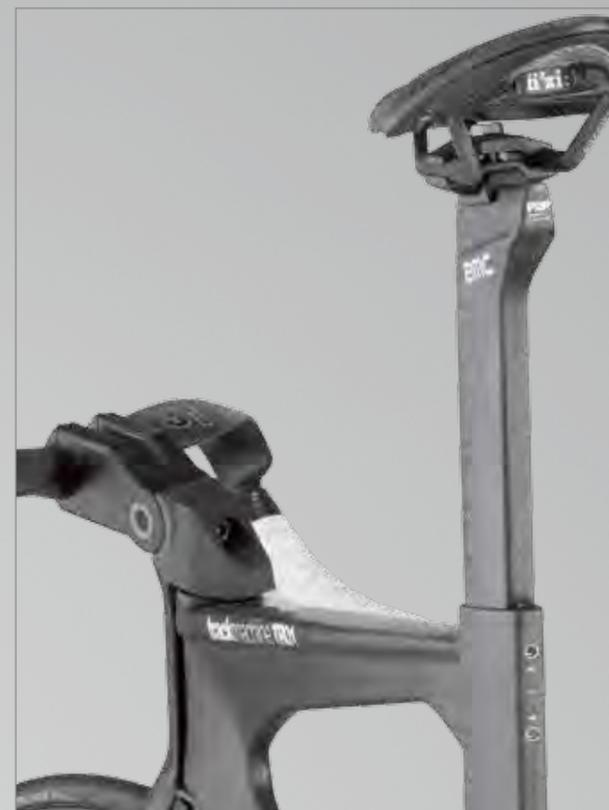
Vue détaillée du Trackmachine TR01 muni de sa fourche à charnière et son système p2p de potence et tige de selle.
