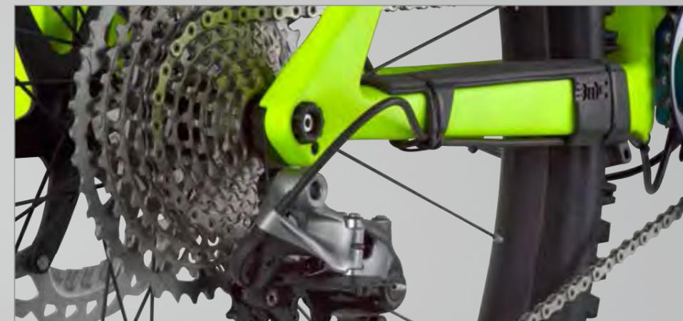
Le Trailfox 01 possède un triangle arrière en carbone avec un axe traversant 12x142 mm, monté avec des pattes de dérailleur spécifiques Sram ou Shimano. L'étrier de frein est au standard post-mount 180 mm.
