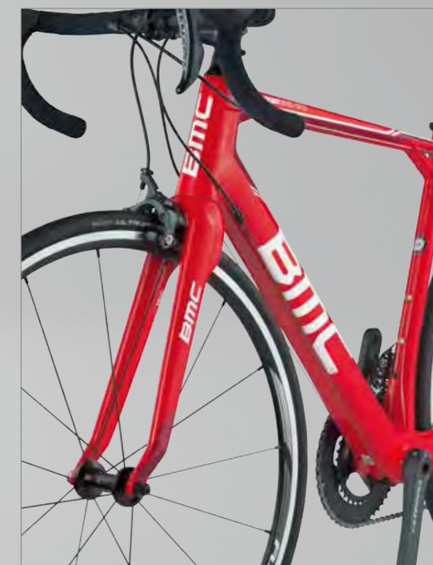
Le TCC (Tuned Compliance Concept) et la technologie Angle Compliance de la fourche agissent avec les pattes de cadre en carbone déportées pour créer une souplesse équilibrée et un pilotage stable.
