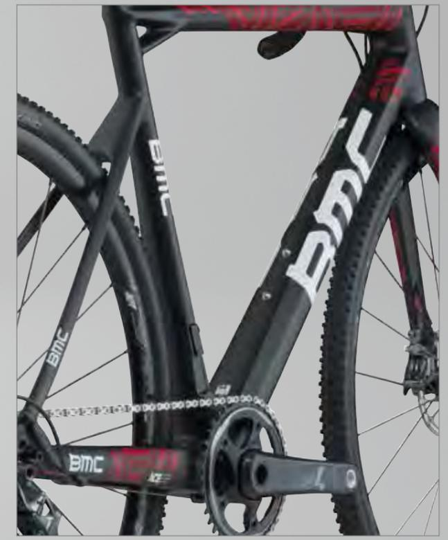
Des haubans bas et fins ajoutés à la technologie Angle Compliance créent un triangle arrière à la souplesse verticale particulièrement efficace.
