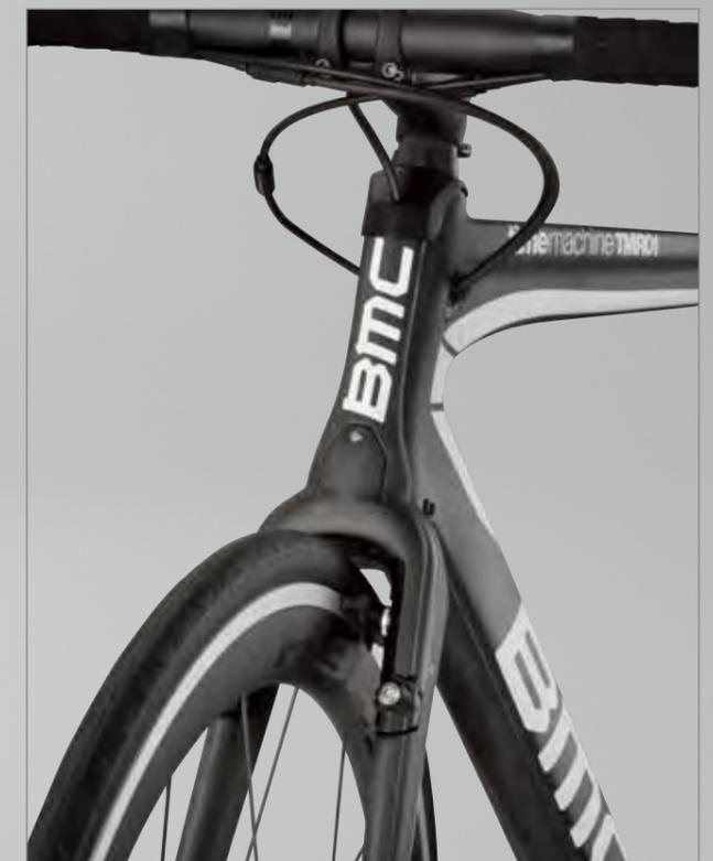
Vue détaillée de la fourche à charnière "hing fork", du frein avant intégré et du passage des câbles DTI.
