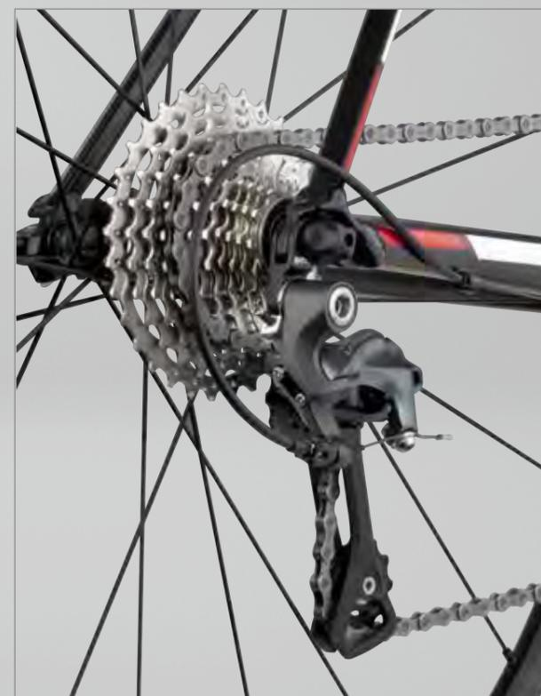
Patte de réarilleur arrière CNC en sandwich pour un changement de vitesses optimisé.
