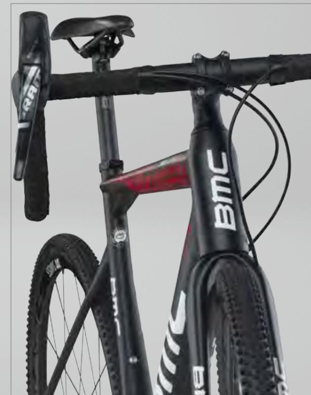
Technologie ACE appliquée au CX01 résulte en une jonction extra large du tube de direction et du tube supérieur.
