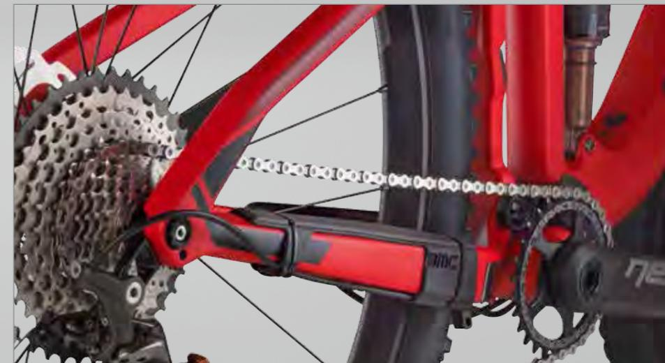
Les bases, très courtes, font partie du concept BWC pour garder un vélo agile et joueur. Le triangle arrière full carbone reçoit un axe en 12x142 mm et des inserts de freins remplaçables.
