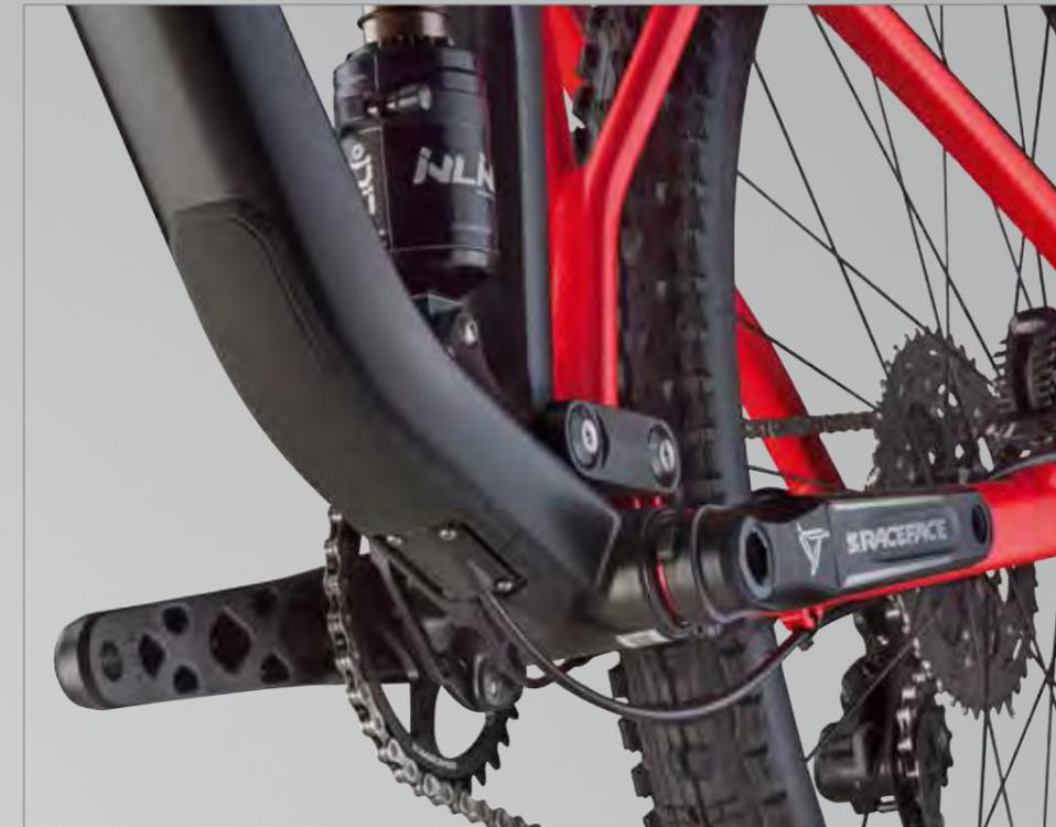
Le système de montage ISCG facilite la mise en place du guide-chaîne.
