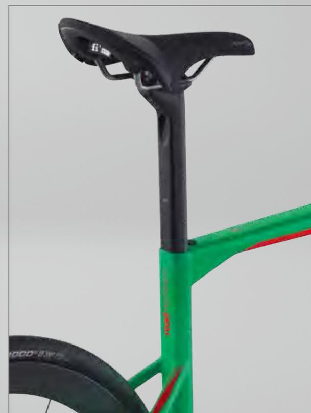
Une nouvelle tige de selle "D" tient en place grâce à un système de serrage intégré.
