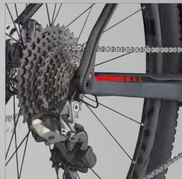
La rigidité de l'axe traversant combinée à une largeur de 142 mm confère un haut niveau de performance à l'arrière du Teamelite.
