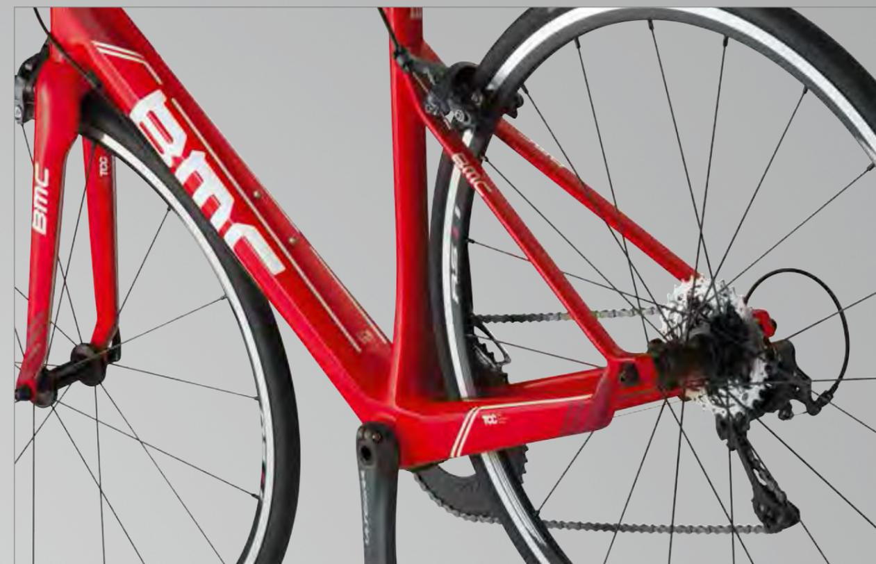
Les haubans fins et abaissés et les points de flexion Angle Compliance du triangle arrière agissent en osmose avec des pattes de cadre en carbone déportées pour un niveau de souplesse maximal.
