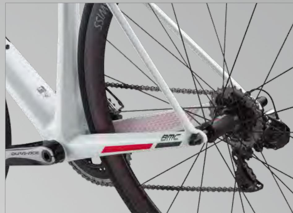
Les formes des bases asymétriques sont le résultat du calcul ACE technologie. Le boîtier de pédalier BB86 est utilisé dans toute sa largeur pour connecter le tube diagonal, le tube de selle et les bases. Le concept DTi permet un passage propre des câbles quel que soit le montage, à travers le tube diagonal et sous le boîtier de pédalier.
