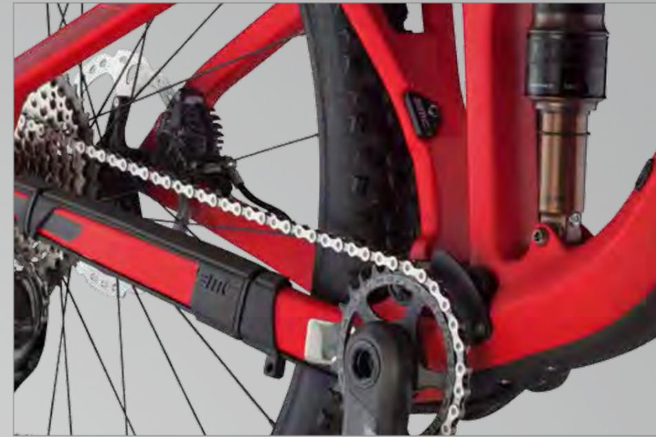
Une conception à l'épreuve des sentiers avec une protection de bases intégrée, des guides chaîne au niveau du cadre et des bases pour garder la chaîne en place. La patte de dérailleur avant est amovible pour s'adapter aux transmissions 1x11 vitesses.
